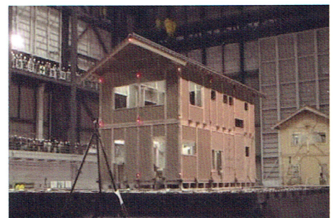
実物大の伝統的木造軸組構法住宅の耐震性能検証実験でも施工した屋根瓦に損傷はありませんでした。(2008年11月実施)
